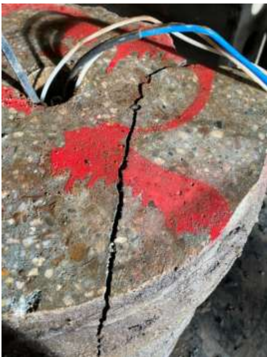
Scheuren over de paal bij het drukken op 70Ton Tabel met aangehouden E-waarde beton:
