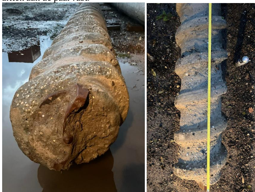
FIGUUR 17 GETROKKEN DPA PLUS PALEN WERKENDAM
