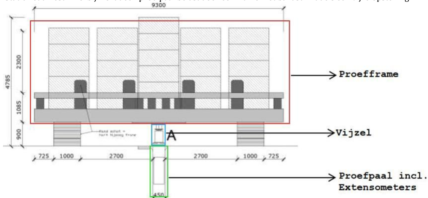
FIGUUR 3 SLT PROEFOPSTELLING
